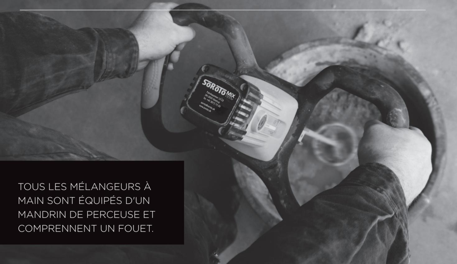
TOUS LES MÉLANGEURS À MAIN SONT ÉQUIPÉS D'UN MANDRIN DE PERCEUSE ET COMPRENNENT UN FOUET.
